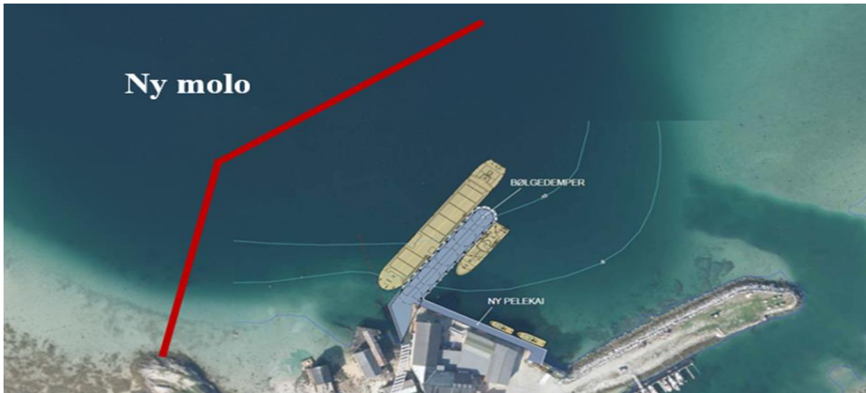
Figur 11.7 Oversiktskart over tiltaksområdet i Brensholmen fiskerihavn, med lokalisering av ny molo og bølgebryterkai*
